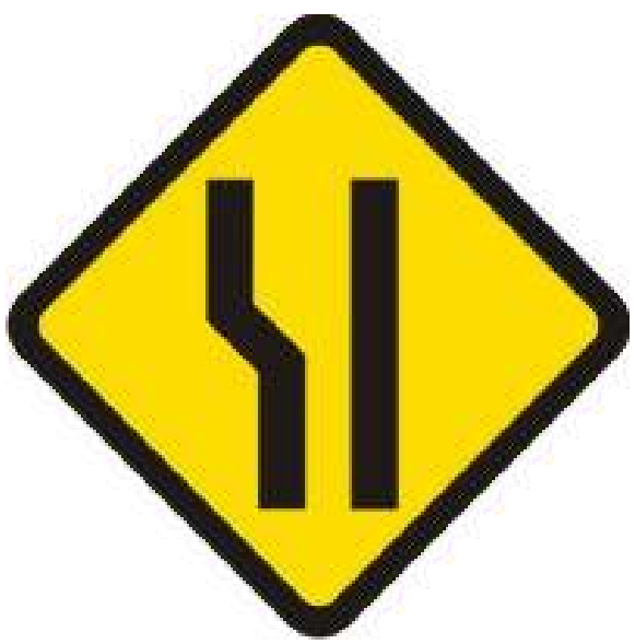
Alargamento de pista à esquerda
