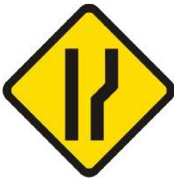
Alargamento de pista à direita
